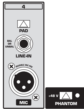
Fig. 3.1: Conexiones de los canales mono
